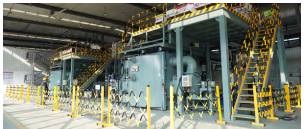
山东稀土钕铁硼甩带片生产车间
