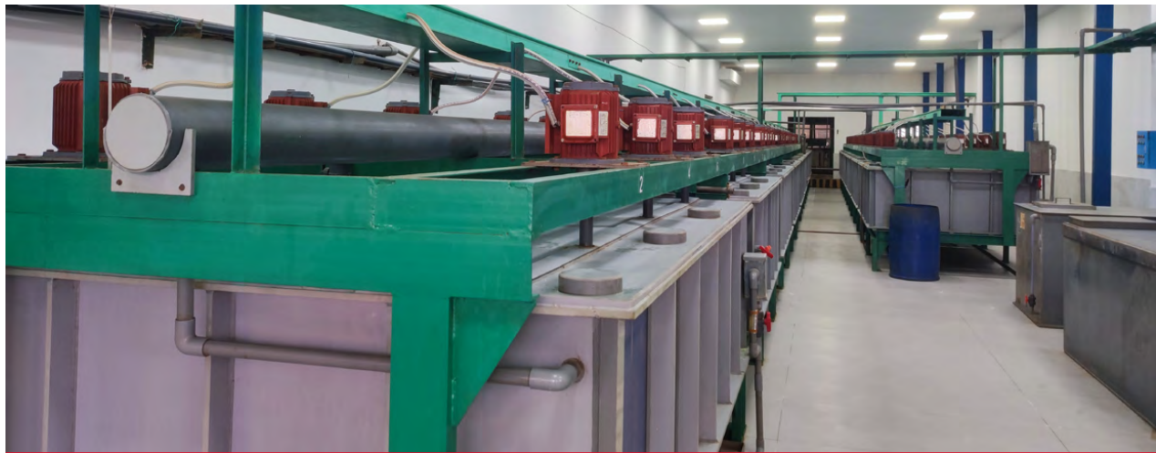
江苏稀土所属公司在氧化钕生产线首次试用并批量更换“双碳”智能电机，噪声降幅达到30%
